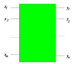
**Definição 7** Um circuito com m entradas e n saídas definido num domínio D e com componentes de uma família  $\mathcal{F}$  é um grafo dirigido acíclico com 3 tipos de nós
