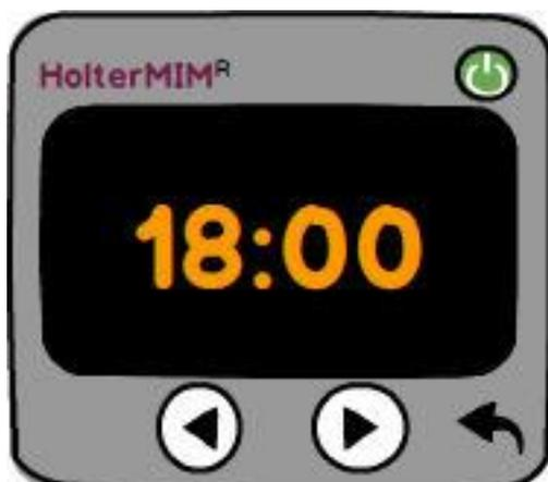
O dispositivo pode ser bloqueado no botão na face superior do dispositivo, sendo que quando tal acontece, o dispositivo mostra o ecrã com o relógio. Para voltar ao menu, basta desbloquear o dispositivo.
