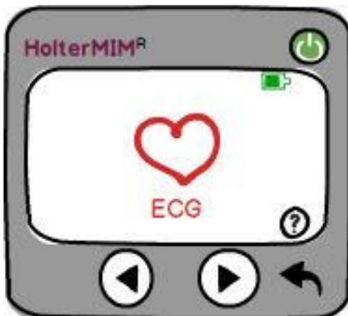
Quando o utilizador é reconhecido, o dispositivo dá-lhe acesso ao menu inicial, que este pode percorrer utilizando os botões de avanço/recuo. O utilizador para poder explorar as diferentes opções basta clicar no *ícone* que aparece no ecrã. A opção ECG permite iniciar a medição do ECG, devendo ser esta opção acionada pelo profissional de saúde. Depois de iniciada, o paciente pode consulta-la.
