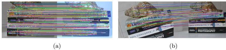
Figura 6: Resultado final da correlação de imagens após cálculo da matriz de homografia.
