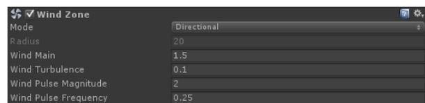
Figura 4: Propriedades do vento: *Wind main* - força do vento, *Turbulence* - turbulência na força do vento, *Pulse Magnitude* - variação do vento ao longo do tempo, *Pulse Frequency* - frequência das mudanças do vento
