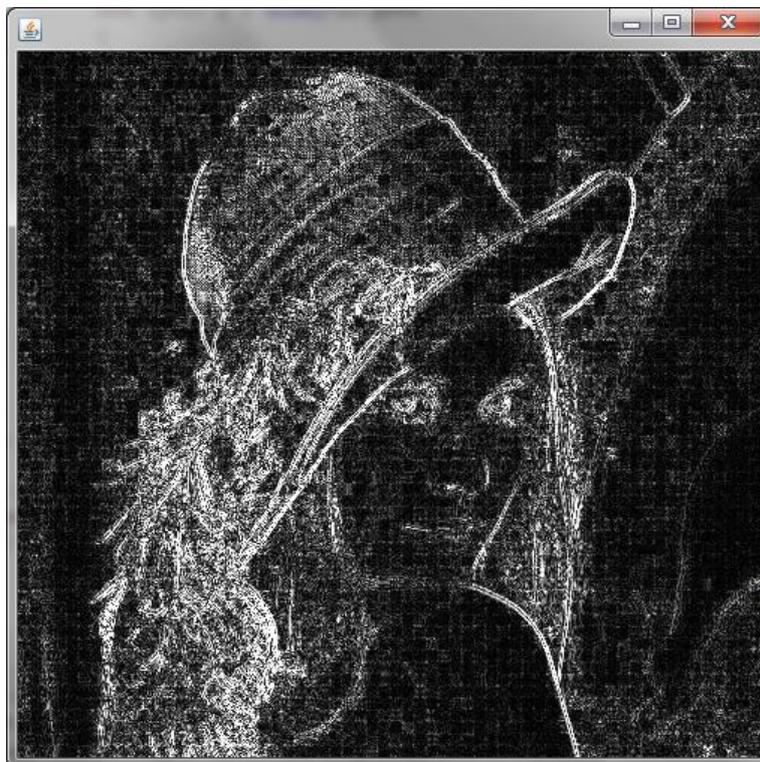
**Figura 1** – Resultado da aplicação de um filtro Laplaciano 3x3 à imagem *lena.jpg*. Para efeitos de visualização, o valor obtido foi multiplicado por 5. Qual será a causa do efeito de ‘quadrícula’ resultante? (*Pista: Leia os slides acerca de compressão de imagem*)
