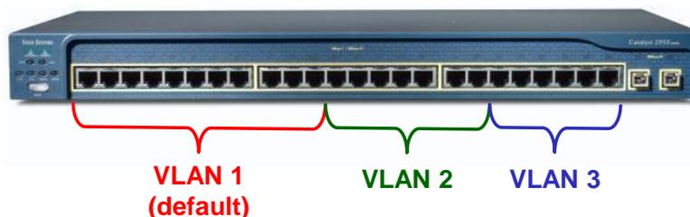
Figura 2 — Atribuição de portas físicas a diferentes VLAN
